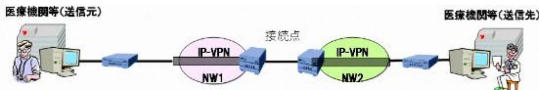
図③-b 中間で複数の閉域ネットワークが相互接続して接続されている場合
